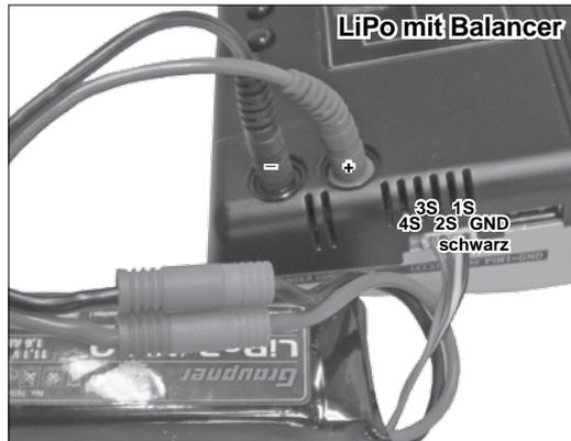
**BEACHT:** Das schwarze Kabel des Balancersteckers (-) muss immer an PIN0 (GND) gesteckt werden, gleichgültig aus wievielen Zellen der Akku besteht und somit Kabel am Balancerstecker vorhanden sind.
