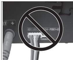
**Balancer plug inserte incorrectly**
